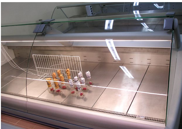
Експериментальна вітрина зі стандартною системою охолодження (європейський виробник)
